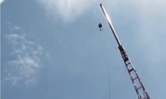
投下テスト 高いところからプールに投下するテスト。 破損することなく膨脹します。
