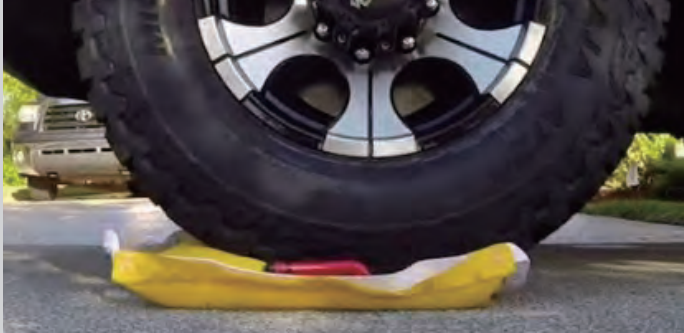
トラックテスト 膨脹状態で、車で踏んでもパンクしません。
